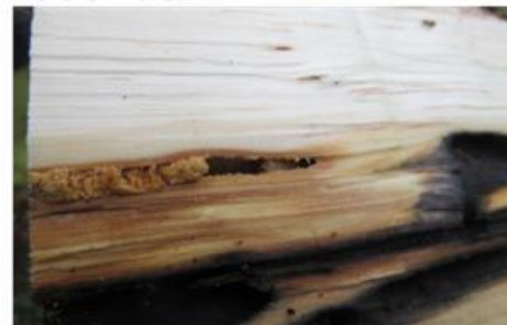
Moschusbock-Gang mit Larve und dicht gepressten Bohrspänen
