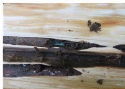
Moschusbock-Gang mit Larve und dicht gepressten Bohrspänen
