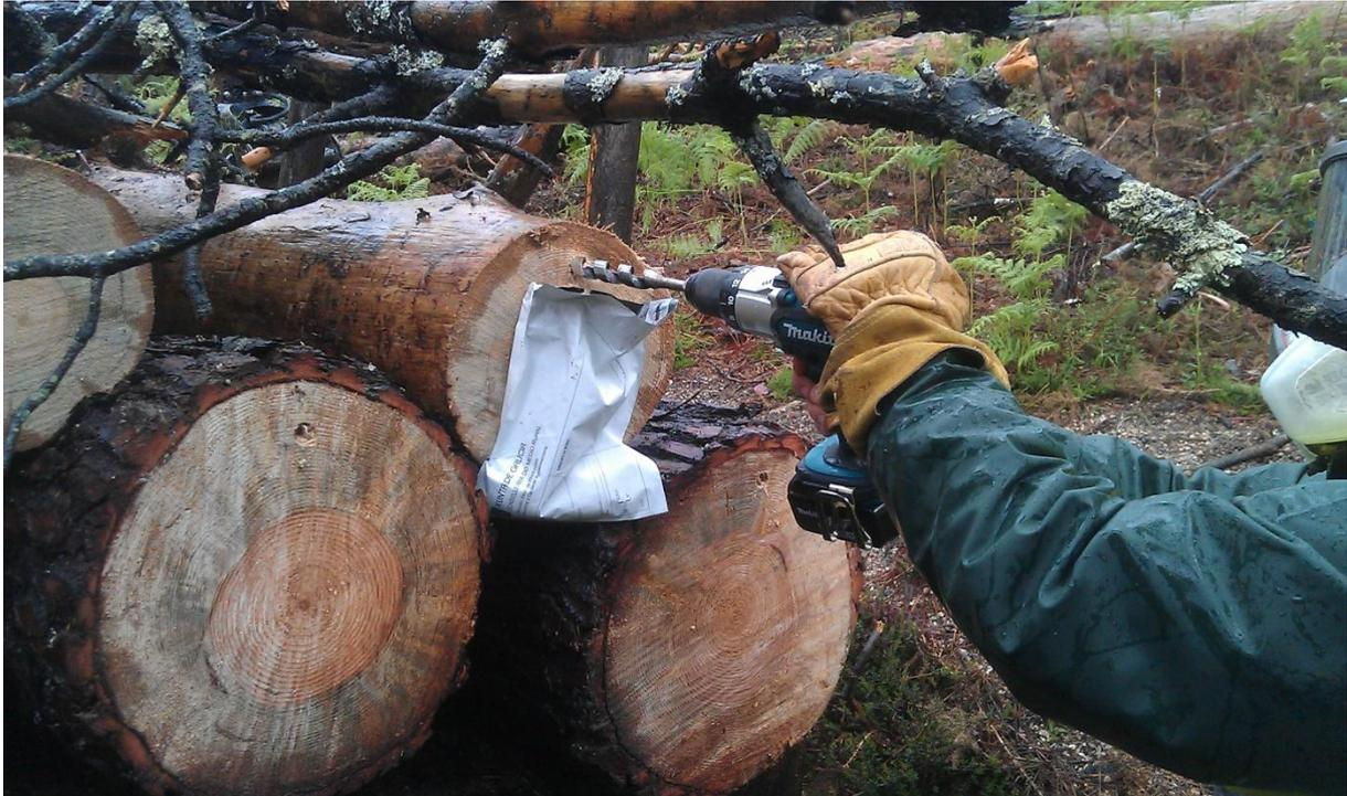
Abb. 10: Probenahme mittels Akku-Bohrmaschine und Schlangenbohrer
