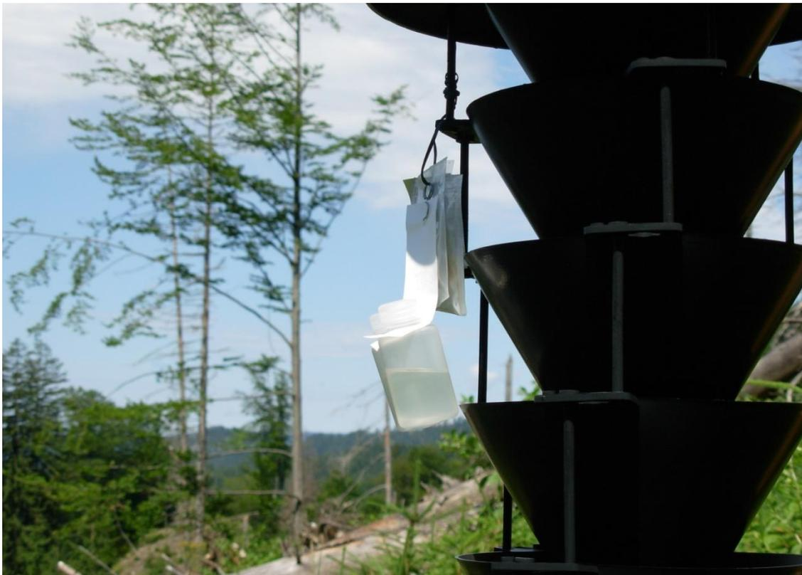
Abb. 11 und 12: Trichterfalle mit Mehrkomponenten-Lockstoff Galloprotect 2D.
