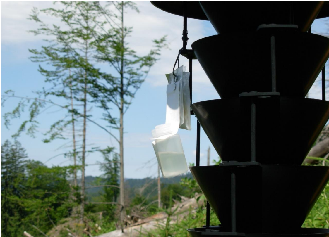
Abb. 11 und 12: Trichterfalle mit Mehrkomponenten-Lockstoff Galloprotect 2D.
